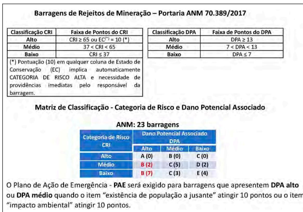
**Figura 29.** Classes das barragens de rejeitos de mineração do estado de São Paulo, segundo dados da ANM, e inseridas na PNSB, com destaque (em vermelho) para aquelas com exigência de PAE.
