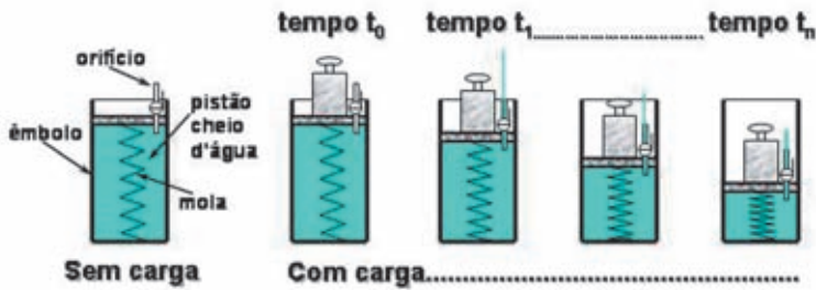
Figura 6.8 - Modelo de analogia mecânica para o fenômeno de adensamento do solo, segundo conceituação de Terzaghi (Fonte: Modificado de Taylor, 1948).
