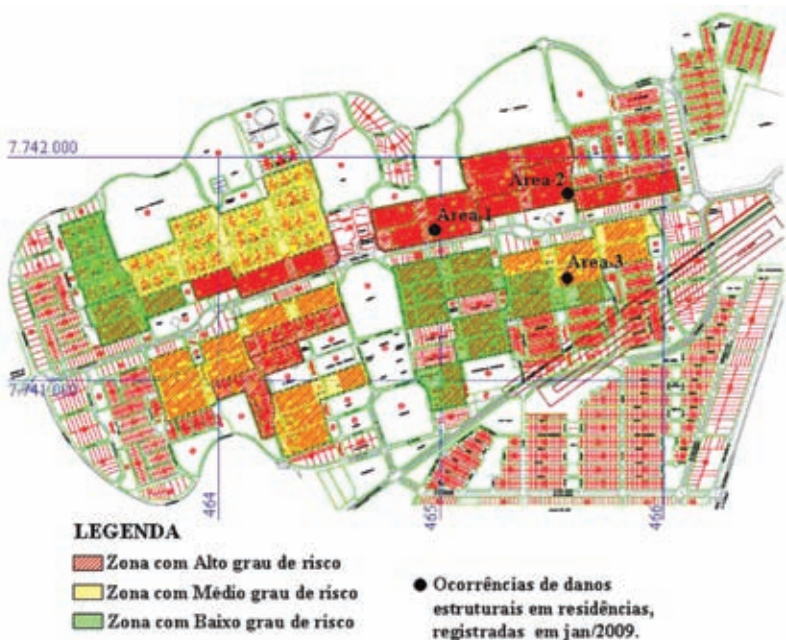
Figura 6.9 - Carta de risco de colapso de solos para a área urbana de Ilha Solteira – SP. (Fonte: modificado de Oliveira, 2002).
