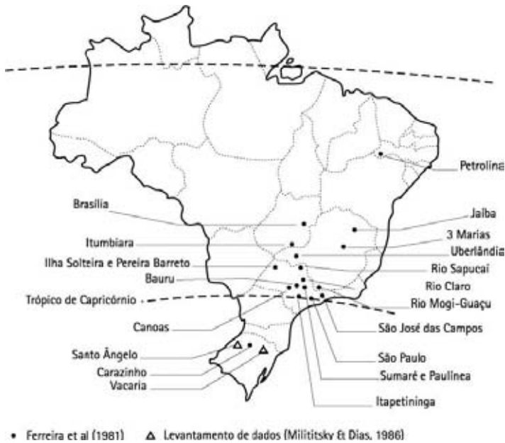
Figura 6.2 - Ocorrência de solos colapsíveis no Brasil (Fonte: Milititsky et al. , 2008).
